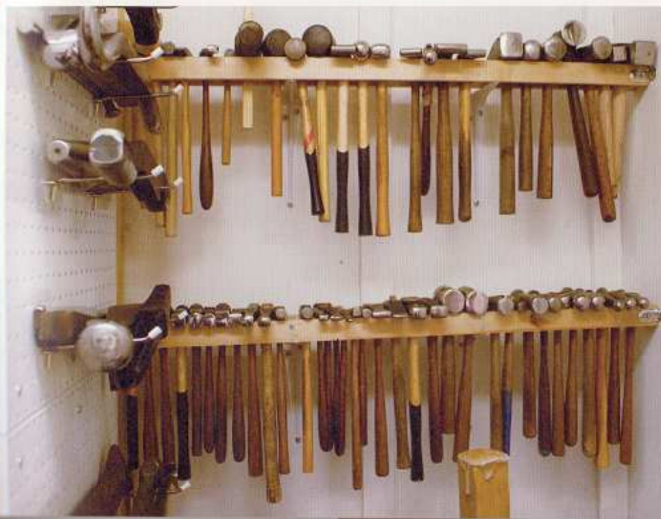
左上：メタルに光沢を与えるために使う道具。左中：店の外にある自転車用通路から入る地下のアトリエ。昔は馬車をひく馬のための小屋として使われていた地下室を、第二の工房として使っている。右上：機械を扱うアトリエに欠かせないのが、救急キット。コンパクトな壁掛け式で、使い方もひとめで分かりやすいデザインになっている。下：ずらりと並んだハンマーは、80本以上！メタルの板を叩いて、形を作る鍛金という加工に必要な道具。
