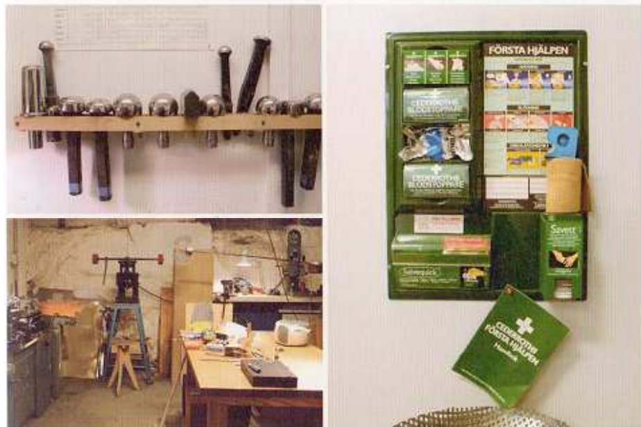
左上：メタルに光沢を与えるために使う道具。左中：店の外にある自転車用通路から入る地下のアトリエ。昔は馬車をひく馬のための小屋として使われていた地下室を、第二の工房として使っている。右上：機械を扱うアトリエに欠かせないのが、救急キット。コンパクトな壁掛け式で、使い方もひとめで分かりやすいデザインになっている。下：ずらりと並んだハンマーは、80本以上！メタルの板を叩いて、形を作る鍛金という加工に必要な道具。
